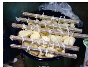
Abbildung 8.7 Von Filtersäcken tropfender Sake
